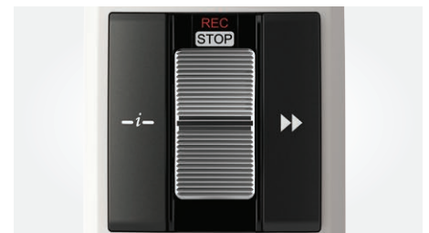
Commande par interrupteur à curseur (enregistrement, arrêt, lecture, retour rapide)
