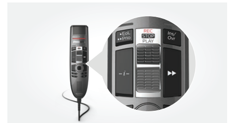
Interrupteur à curseur (enregistrement, arrêt, lecture, retour rapide)
